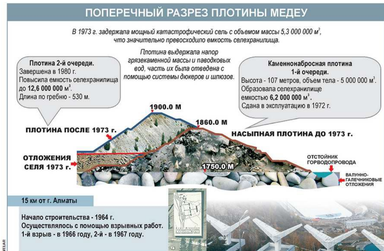
Рис.12.1. Поперечный разрез тела плотины Медеу.
