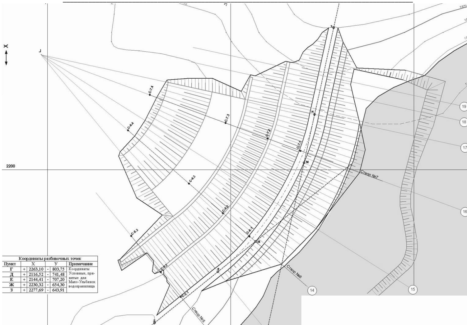
Рис.П7.План установки пьезометров плотины №2.
