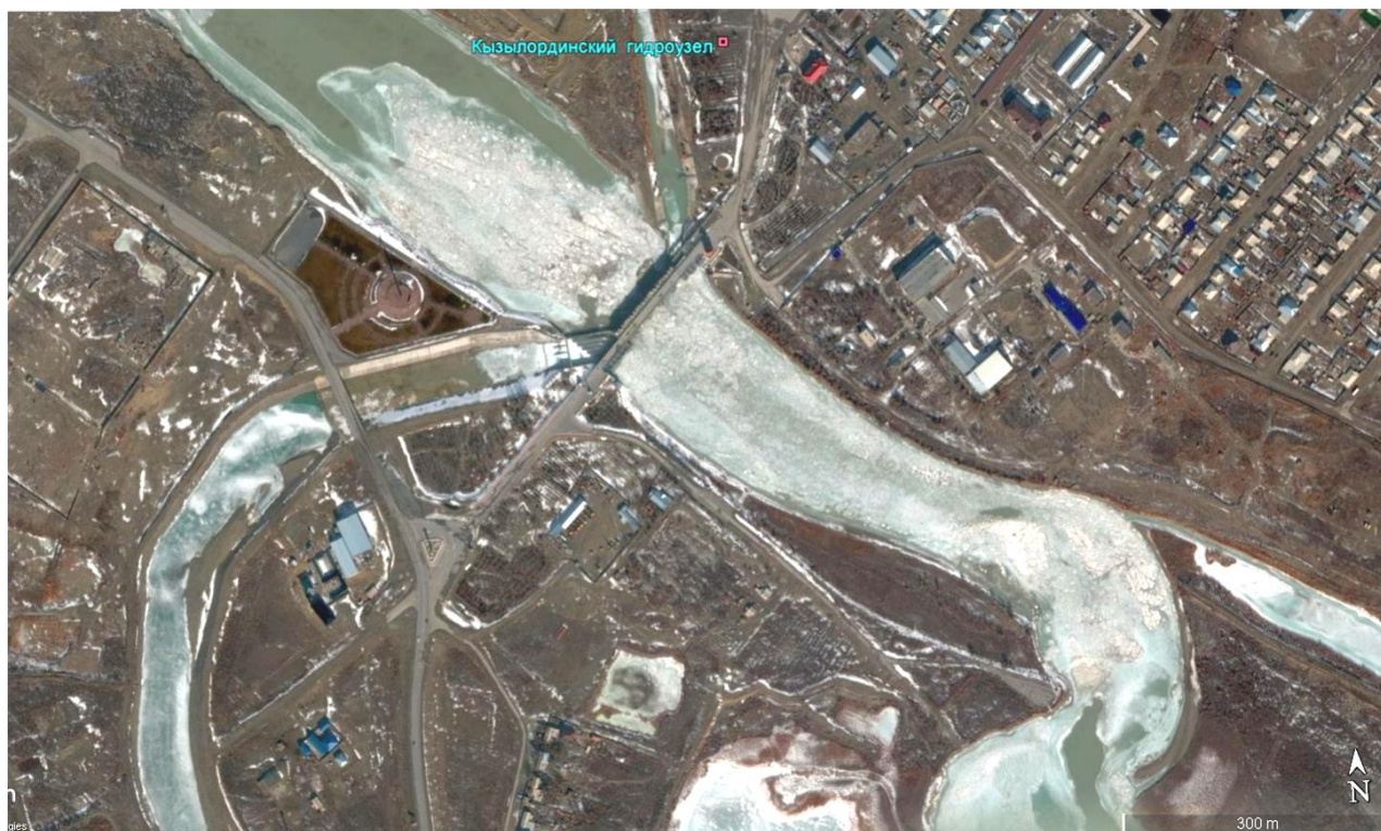
Рис.7.11. Ледовые явления на Кызылординском гидроузле.
